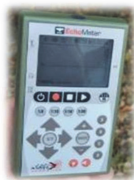
Figure 16 : Détecteur-Enregistreur d'ultrasons Echometer 3 (EM3)
